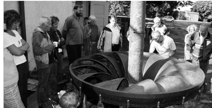
Vor dem Wertachkraftwerk erläutert uns Heinrich Winter die Wirkungsweise der alten Francis-Turbine
